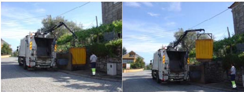
Colocação do contentor no interior da cuba.
