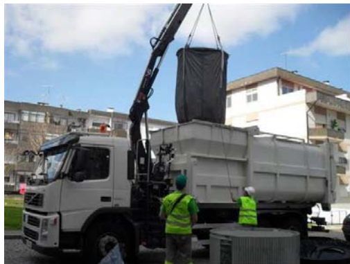
Descarrega do saco de elevação.
