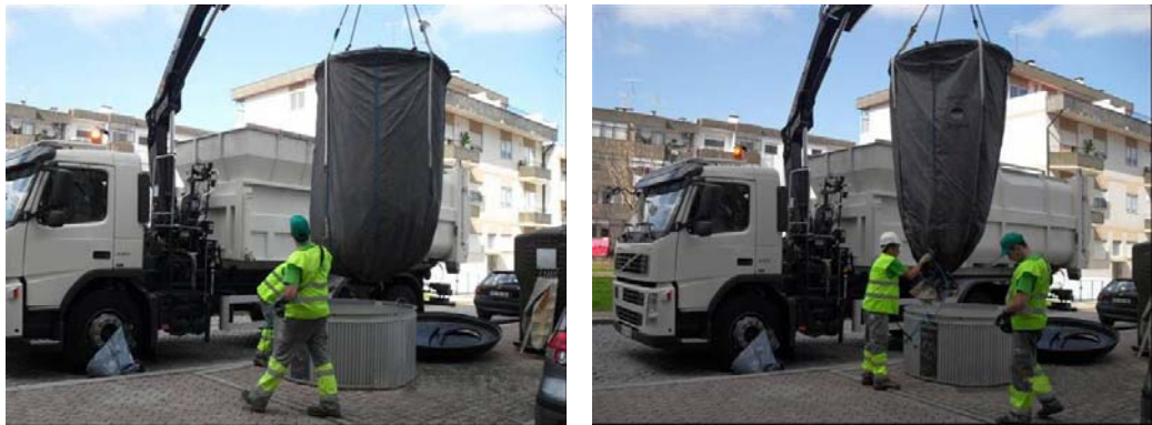
Procedimentos a adoptar na recolha de um molok.
