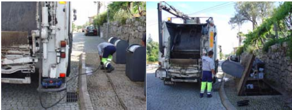
Activação do sistema hidráulico e abertura da tampa
