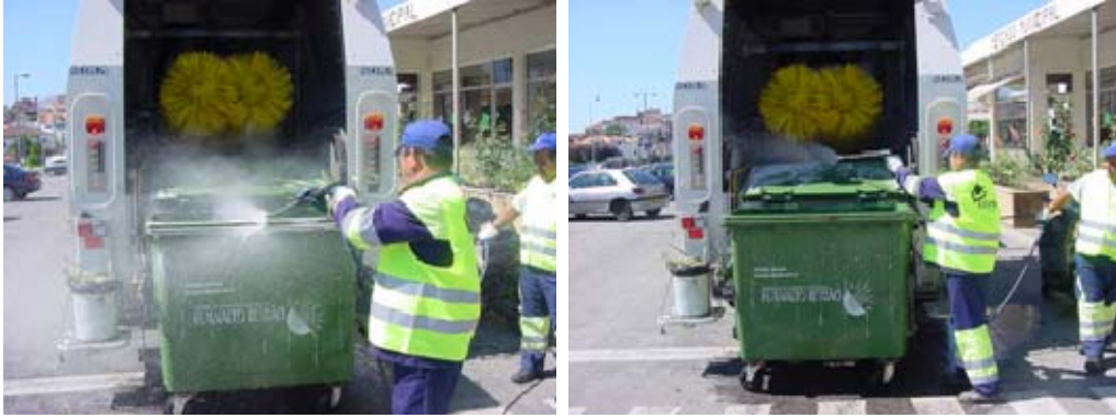
Lavagem dos rebordos e tampas.
