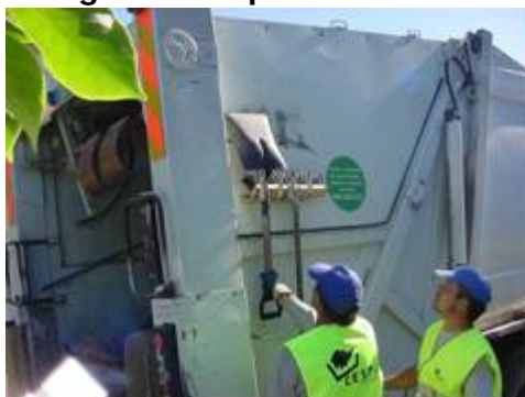
Ferramentas de limpeza, que acompanham a viatura de recolha.
