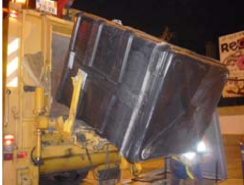
Basculamento do contentor de 3.000L
