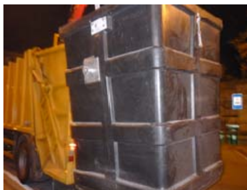
Movimento de retirada do contentor do poço.
