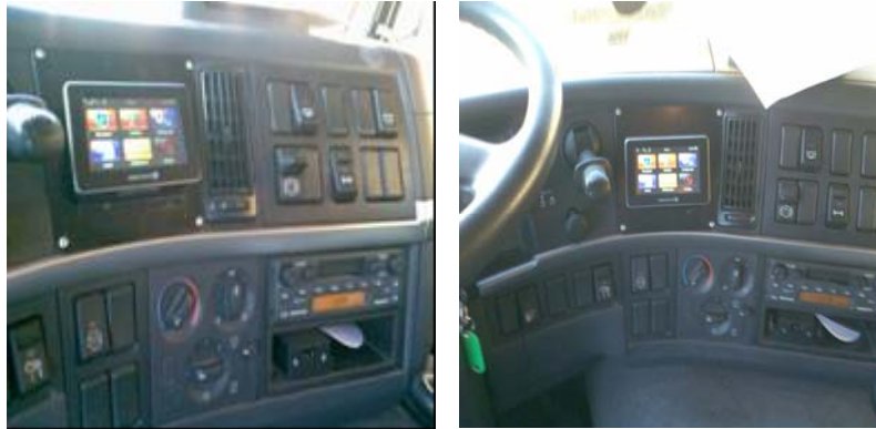
Imagem da instalação no tablier de uma viatura
