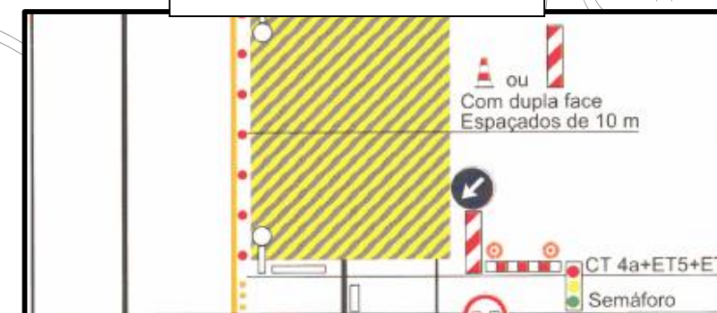
Frente obra – Abertura de Vala
