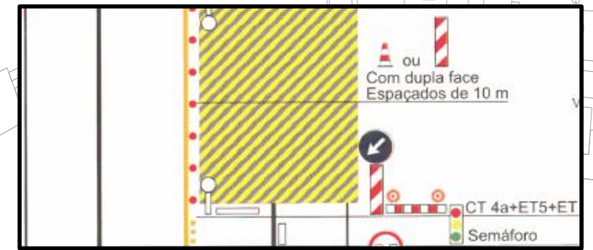
Frente obra – Abertura de Vala
